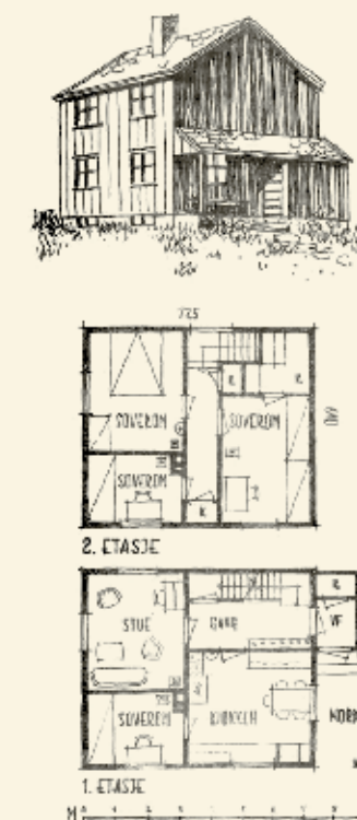
Typenhausentwurf aus dem 1947 erschienenen Katalog des Boligdirektoratet, der in Gamvik häufig gebaut wurde (aus: Boligidirektoratet, Hustegning fra Gjenreisnings skissebok , 1947)
